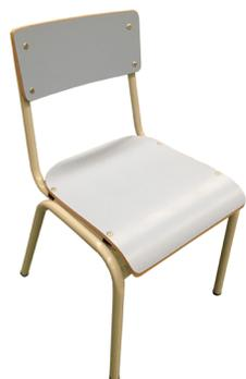
Silla escolar, compuesta por estructura metálica de tubo de Ø25x1,5 mm (patas) y de Ø22x1,5 mm (respaldo) y por dos piezas de madera contrachapada curvada de 10 mm de espesor, con superficie y contratiro de laminado de alta presión (HPL) con cantos redondeados. Incorpora conteras de goma en la base de las patas para reducir el deslizamiento, la vibración y el ruido. Apilables para aprovechar el espacio y reducir el impacto ambiental en su transporte. Acabado de la estructura en pintura Epoxi.
